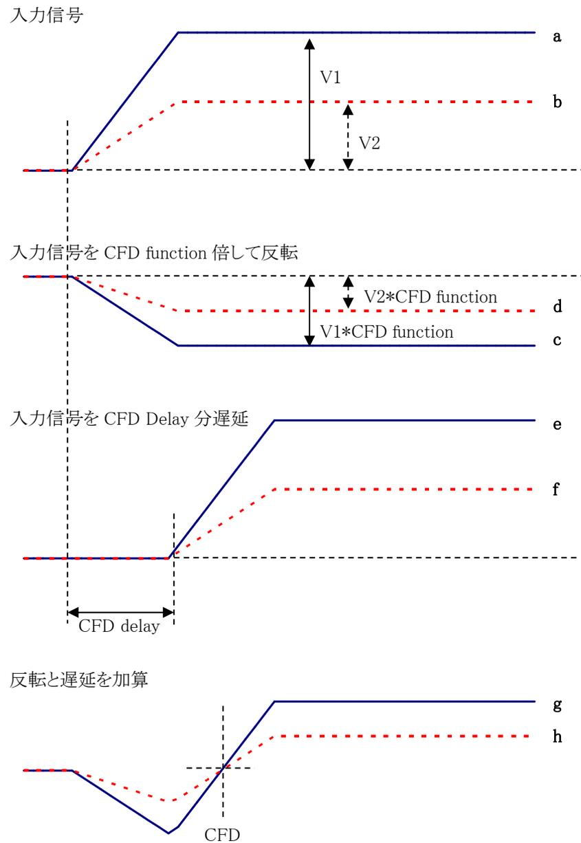
図 7 コンスタントフラクションタイミング (Constant Fraction Discriminator Timing) の考え方
