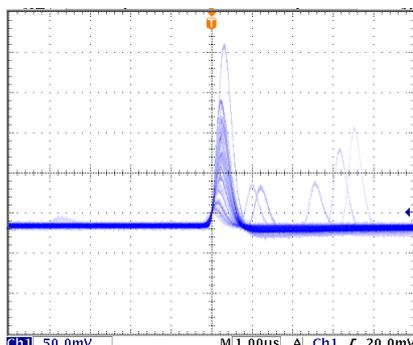
図 32 FAST 系フィルタ (fast diff 50、fast integral 50 の場合)
