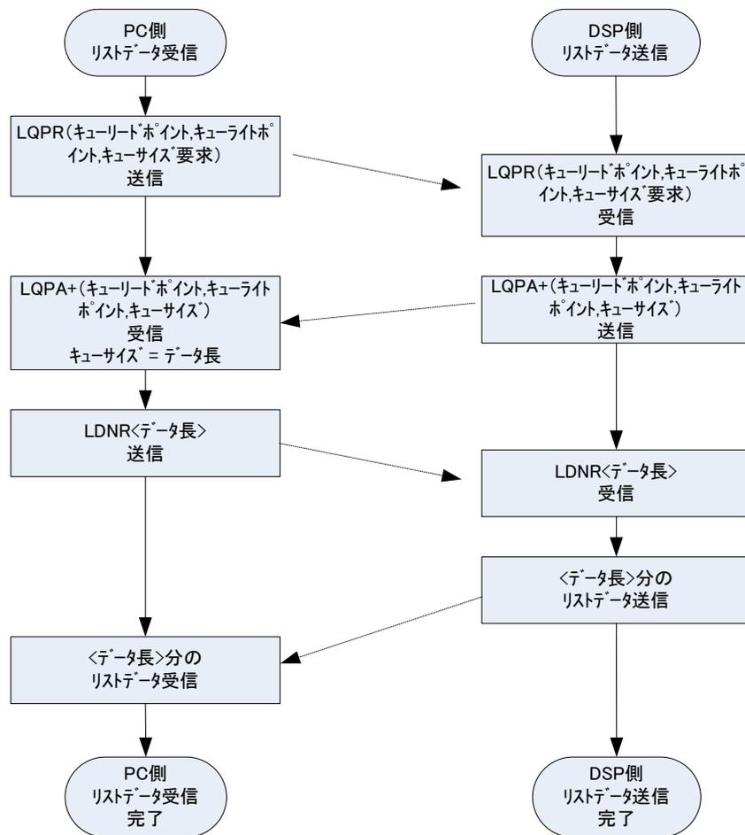
図 43 リストデータ処理フロー (LQPR、LDNR コマンドの場合)
