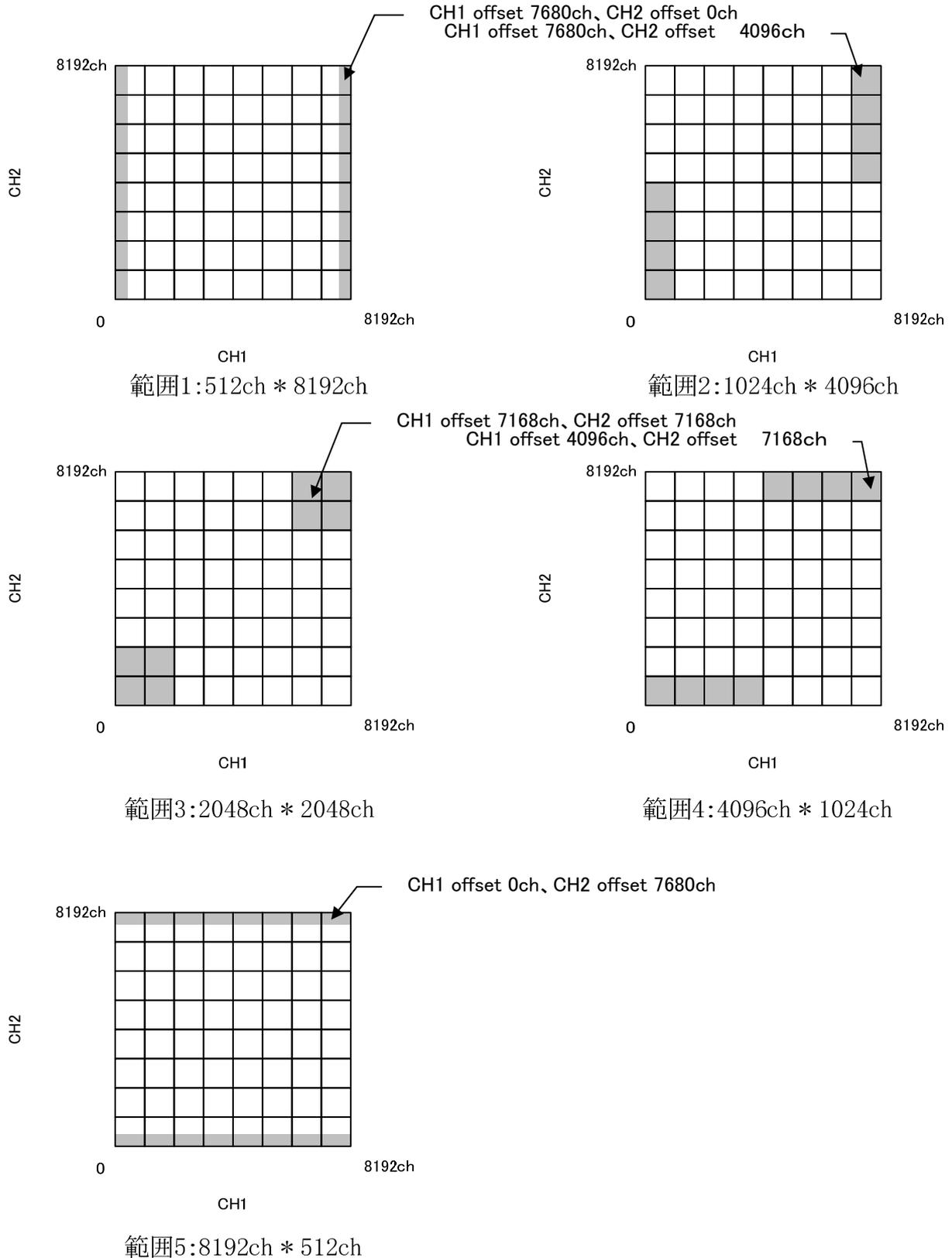
CH1 offset CH2 offset :2次元ヒストグラムを作成する際の先頭位置(ch)を設定します。設定範囲は0から7680(8192-512)です。
