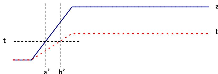
図 6 リーディングエッジ(Leading Edge Timing)の考え方
