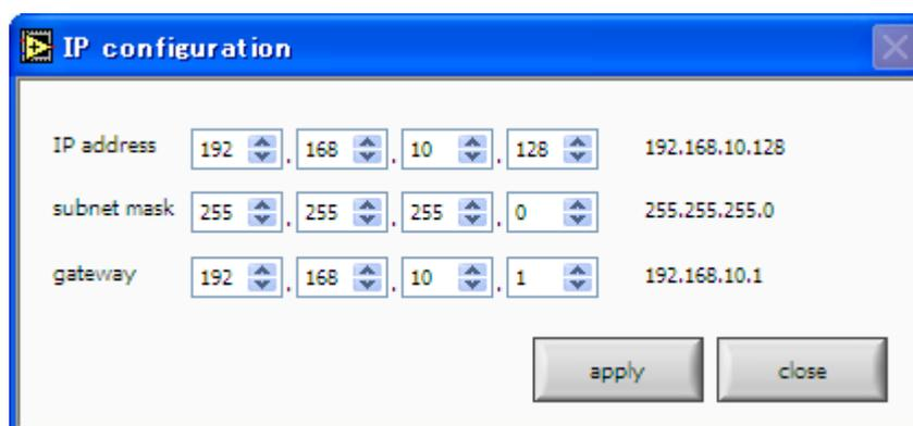
(2) 画面「IP configuration」にて、DSP に設定する値を入力します。画面右側には変更前の値が表示されます。下記の例では「IP address」だけ「192.168.10.130」と変更しています。
