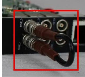
写真 2 SYNC-O 端子と SYNC-I 端子とを相互接続
