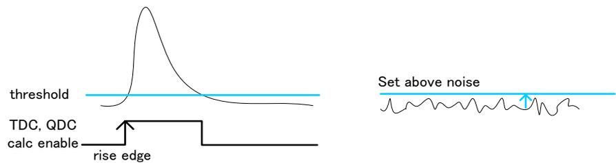
APV8108 及び APV8516 のコンスタントフラクショントイミングは FPGA によるデジタル信号処理にて実現しております。
