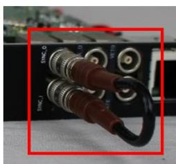
写真 3 SYNC-I/O 端子接続例
