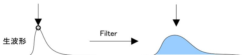
QDC pre trigger (ns) 積分値算出用に波形整形を開始するタイミングを0ns、-8ns、-16ns、-24ns、-32ns から選択します。
