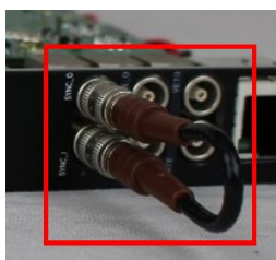
写真 3 SYNC-I/O 端子接続例
