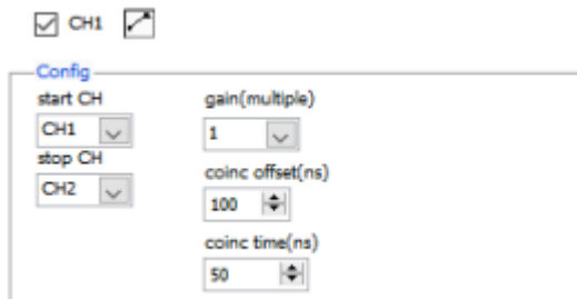
図 39 timespectrum タブ内時間スペクトル計測設定
