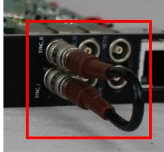
写真 2 SYNC-O 端子と SYNC-I 端子とを相互接続
