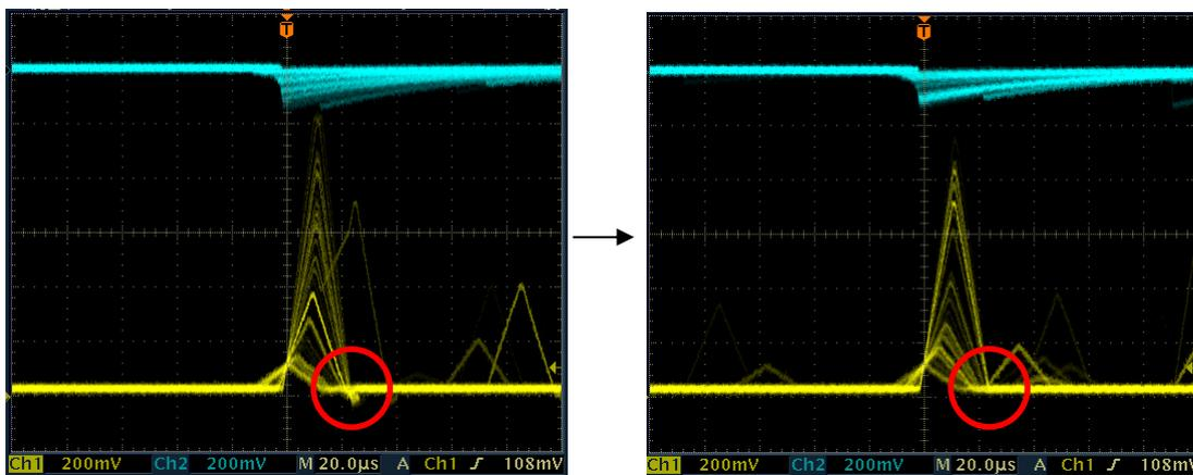
図 42 slow pole zero (左側：調整前 (アンダーシュート有り)、右側：調整後)
