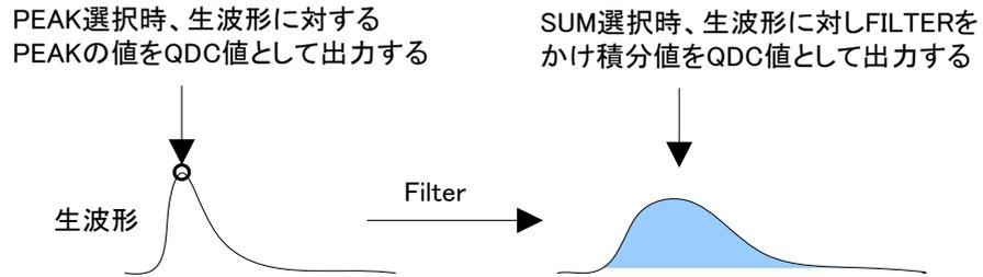
**QDC pretrigger** 積分値算出用に波形整形を開始するタイミングを、0ns、-8ns、-16ns、-24ns、-32ns から選択します。
