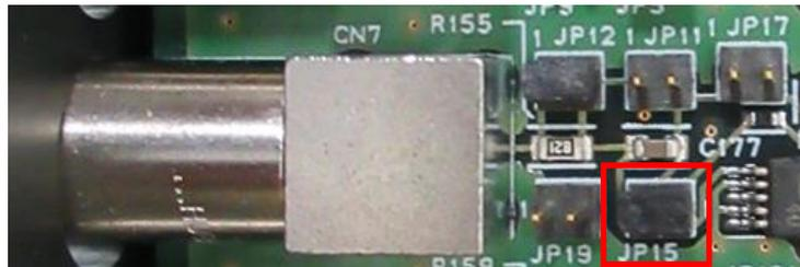
写真 6 トランジスタリセット型設定（CH7 の場合 JP15 を挿します）
