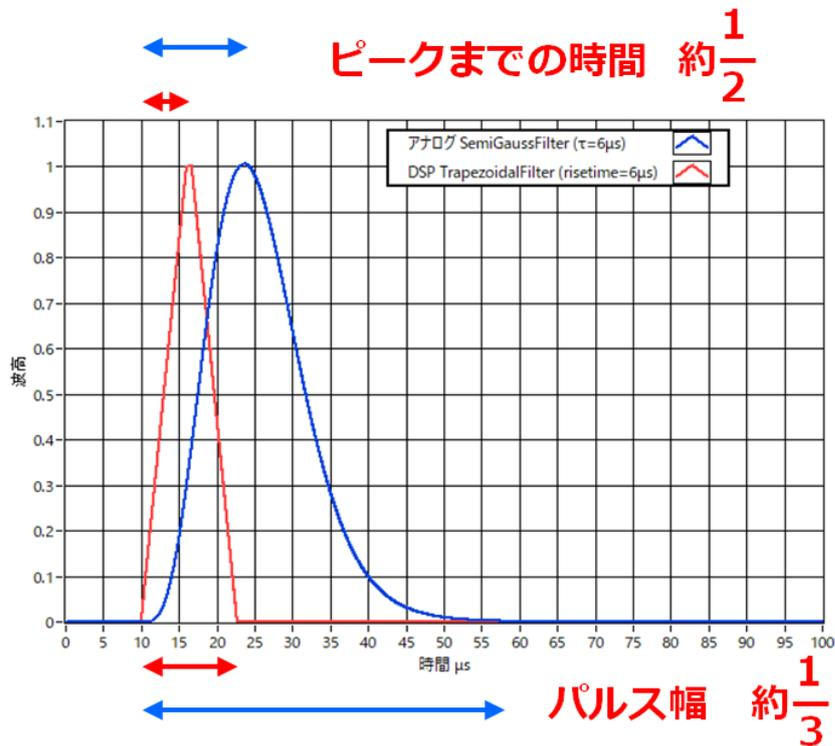
図 40 Trapezoidal Filter と Semi Gauss Filter の応答の違い
