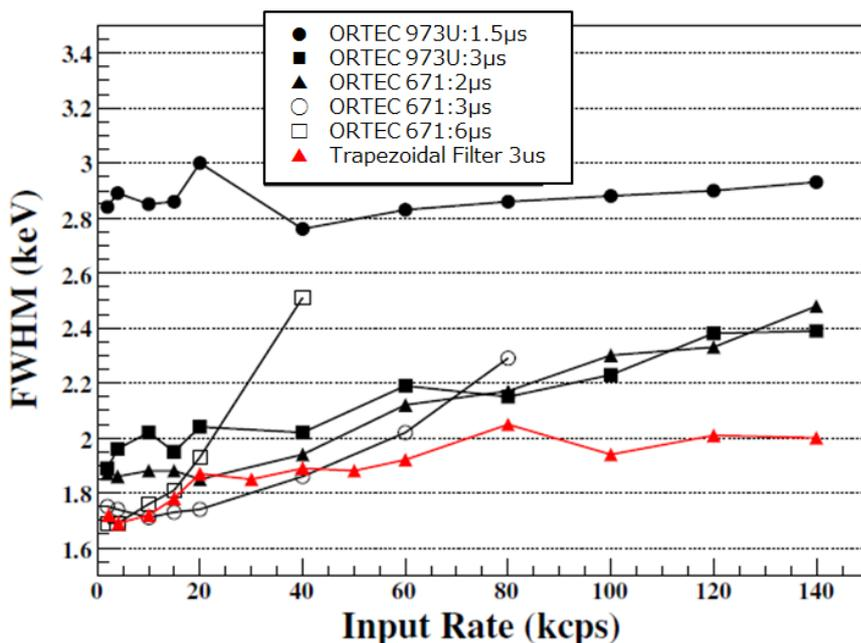
図 41 Trapezoidal Filter と Semi Gauss Filter の計数率とエネルギー分解能の違い
