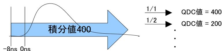
**signal type** 入力波形のタイプを選択します。NIM 信号や Timing 信号入力時は fast sig に設定してください。その他は normal sig を設定してください。
