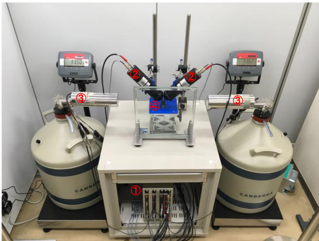
写真 1 陽電子消滅寿命/ドップラー拡がり測定装置と機器構成例 ※別途 PC も必要です
