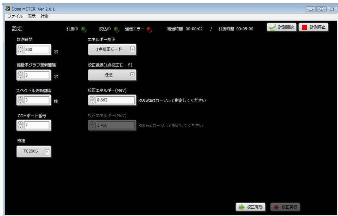
「校正エネルギー(MeV)」に、校正を行う線源のエネルギーの値を入力し、スペクトル表示に切り替えます。
