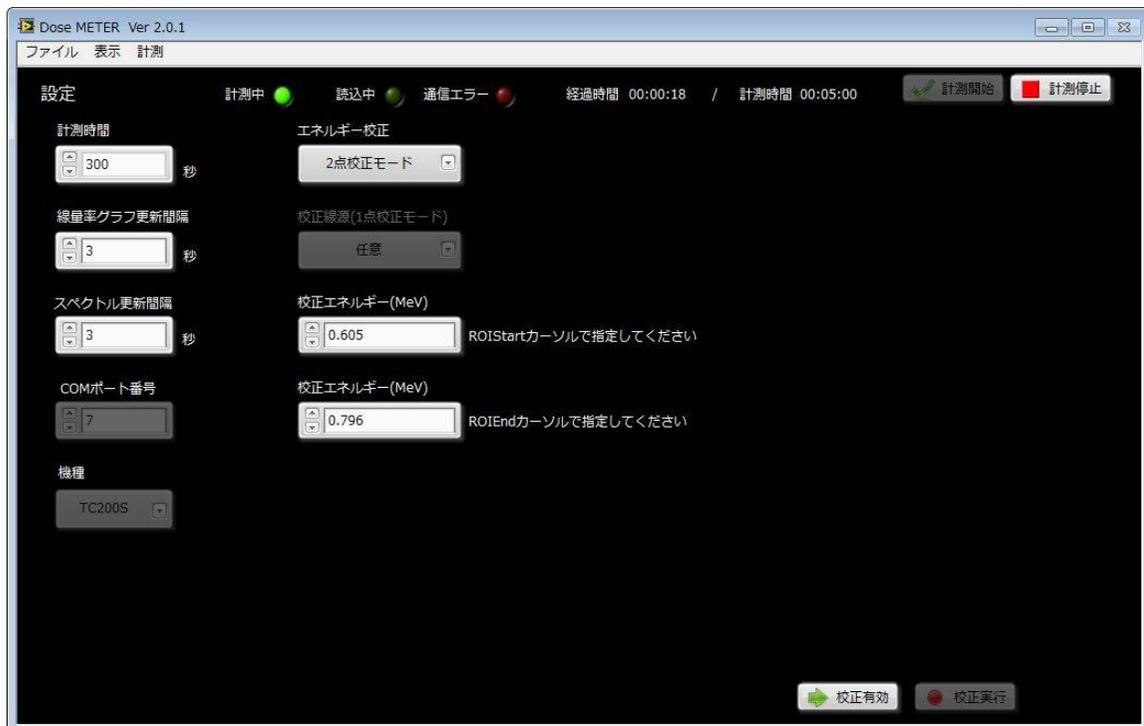
「校正エネルギー(MeV)」2箇所(「ROIStart」カーソルは低エネルギー側、「ROIEnd」は高エネルギー側)に、校正を行う線源のエネルギーの値を入力し、スペクトル表示に切り替えます。
