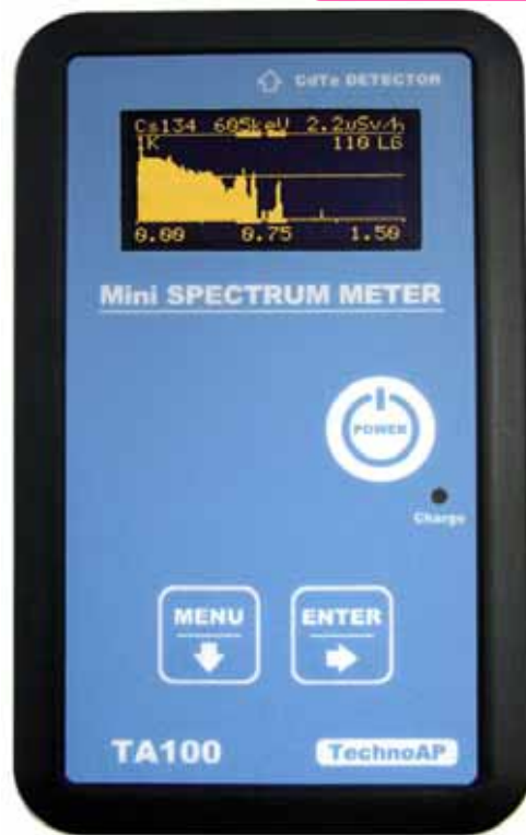
スペクトルモード (計測例: 土壌の ^{134}\text{Cs} と ^{137}\text{Cs} )
