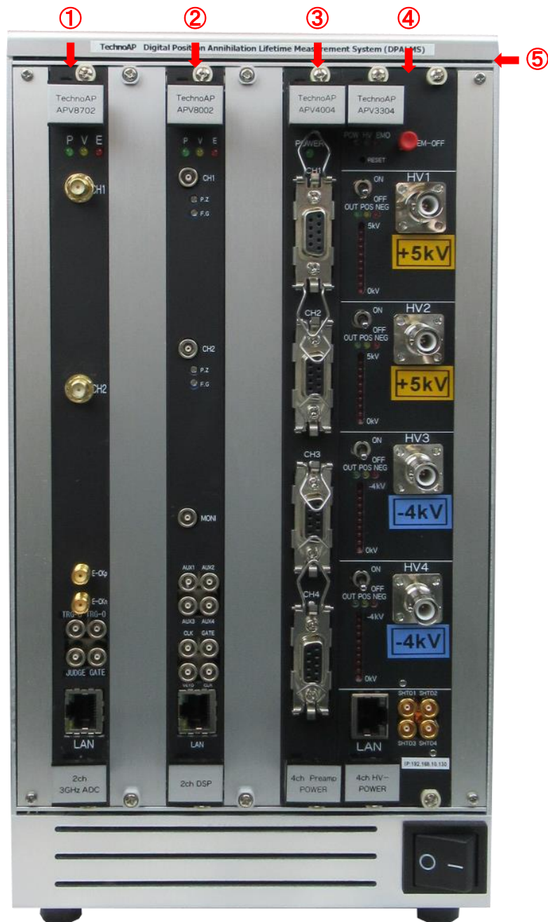
写真 2 デジタル陽電子消滅寿命／ドップラー拡がり測定装置一式 高さ:約 32cm 幅:約 17cm 奥行:約 40cm
