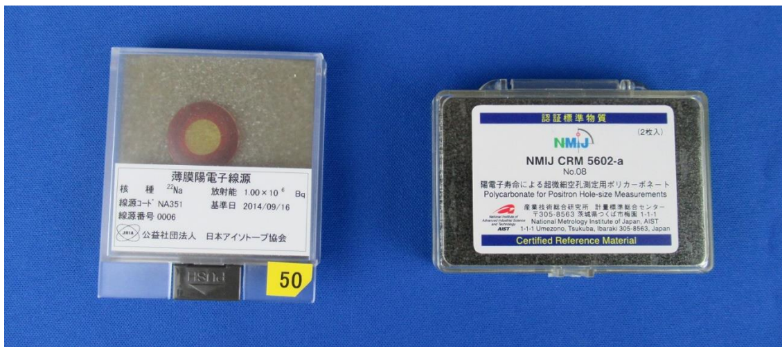
写真 4 左)日本アイソトープ協会製 薄膜陽電子線源 ^{22}\text{Na} 右)標準物質ポリカーボネート
