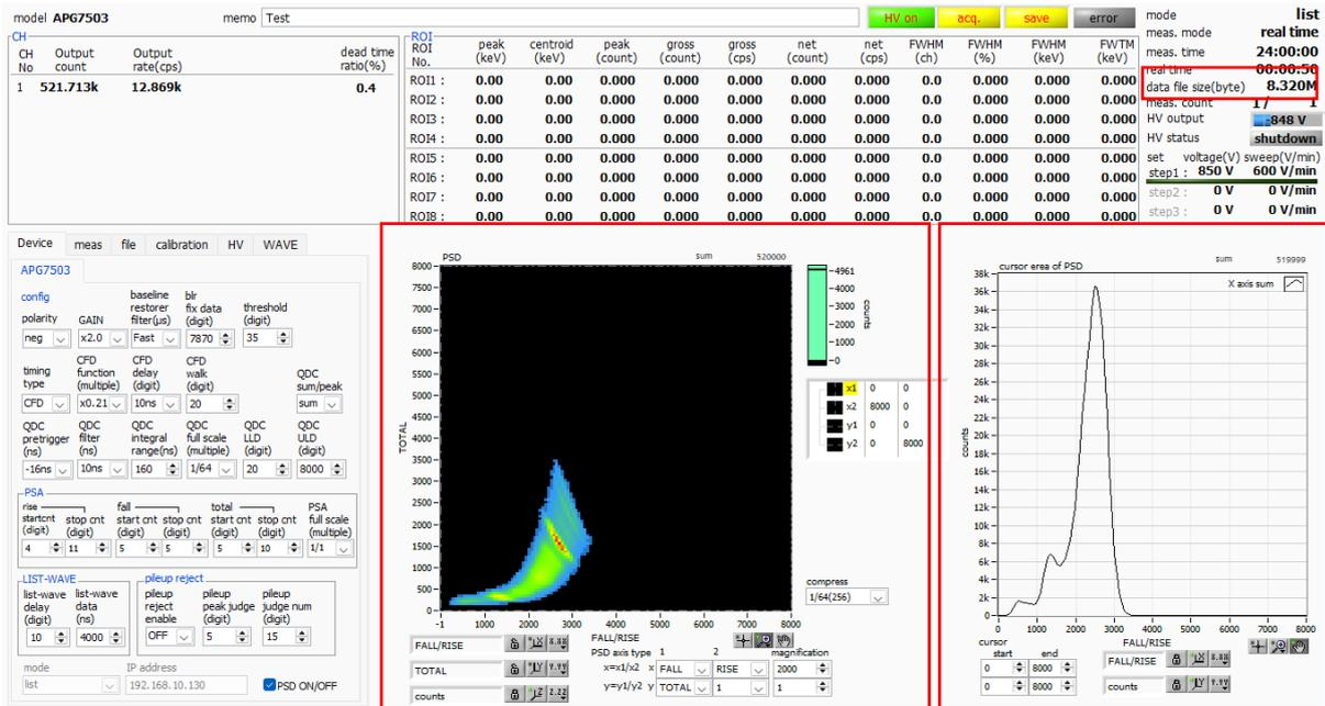
図 35 list データ計測中、PSD グラフと cursor area グラフ更新
