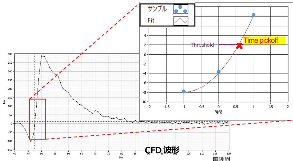
timing type タイムスタンプする際の波形を、CFD 波形または LE 波形から選択します。
