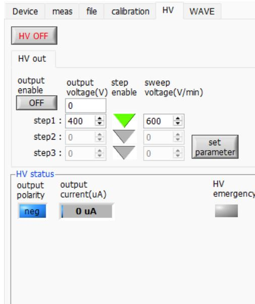
図 17 HVタブ (HV outタブ)
