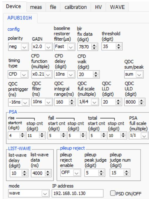
図 25 波形計測設定
