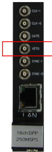
図32. 外部トリガー信号接続箇所
